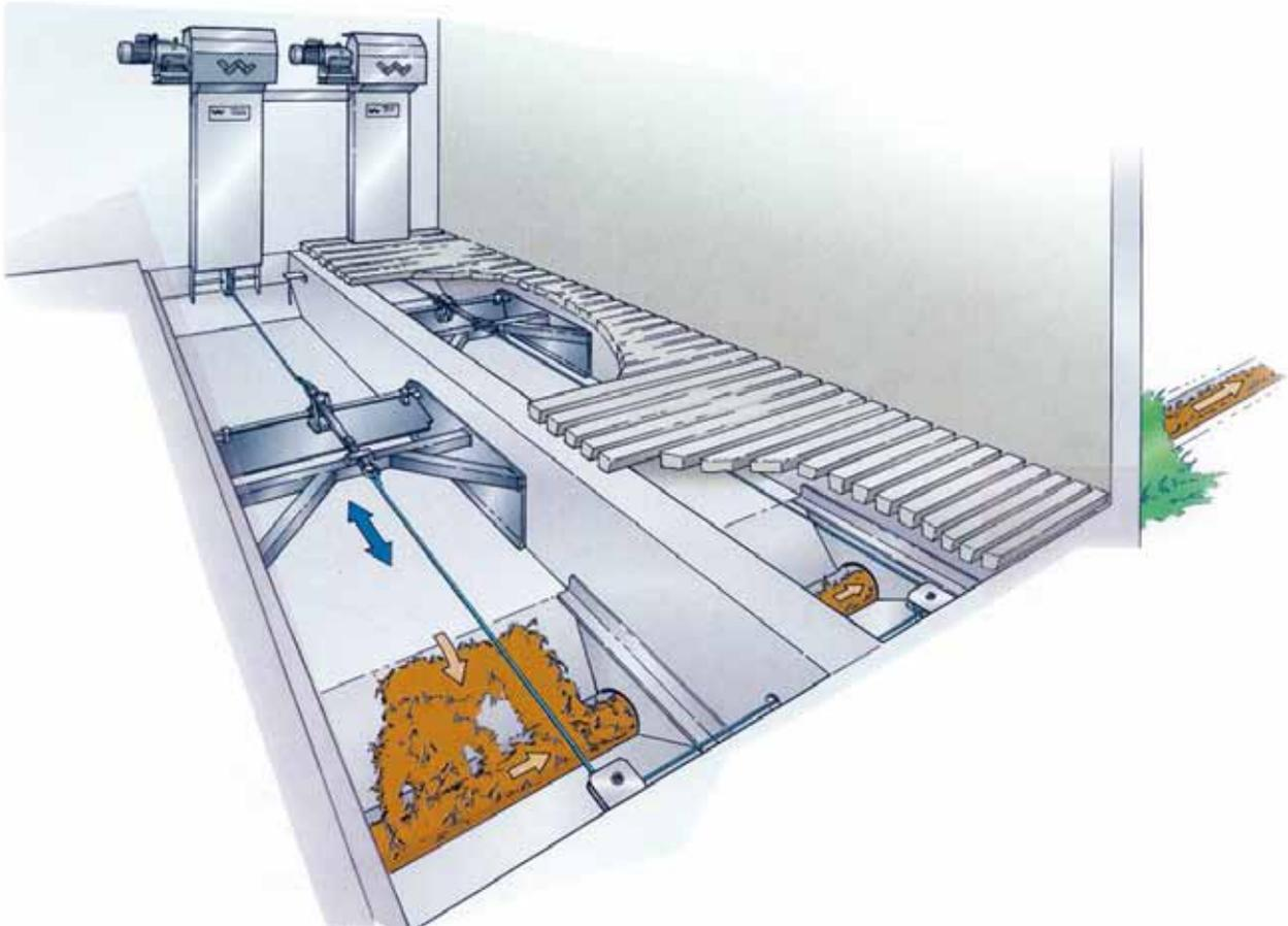
Die Domino Seilzuganlage ist selbstspannend, dies wird erreicht durch die Anwendung von zwei Zugstationen in Kombination mit Stahl- (starrer Teil) und Nylonseilen (flexibler Teil).
